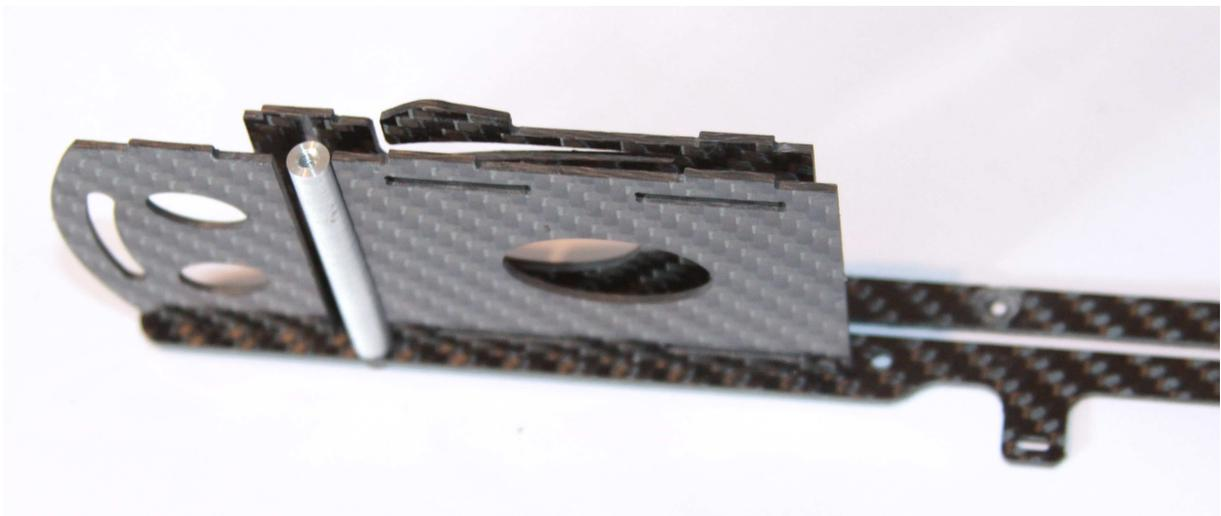
2. Innenschiene aufstecken und mit dem vordersten Verbinder verschrauben.
