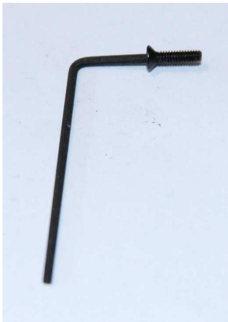
Die Senkschraube auf den Schlüssel stecken
